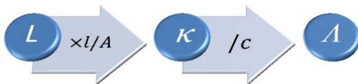
Rysunek 1. Zależności pomiędzy przewodnością L , przewodnością właściwą \kappa i przewodnością molową \Lambda .
